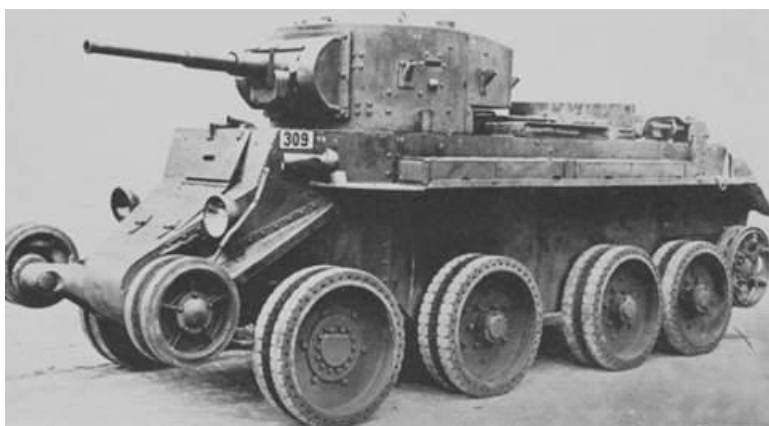
FIGURE 3.3 – Ces chars soviétiques, équipés de chenilles démontables, étaient conçus pour rouler sur les autobahns allemandes.
