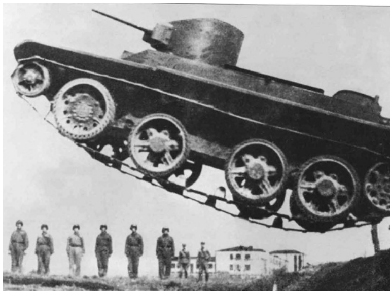
FIGURE 3.2 – Genghis Khan conquiert le monde au moyen de hordes de troupes armées légèrement et de brillantes manœuvres, et non avec des armes puissantes. Les blindés BT soviétiques furent conçus sur des principes similaires : dotés d'un blindage réduit et capables d'atteindre des vitesses exceptionnelles, ils furent produits en grandes quantités.
