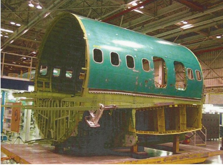
FIGURE 11.3 – Zone du fuselage où se fixent les ailes, les trains d’atterrissages principaux et contenant le réservoir principal de carburant
