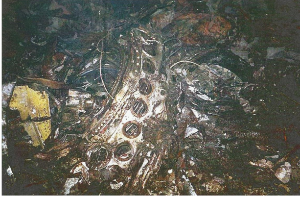
FIGURE 12.13 – Pièce de réacteur trouvée à l'intérieur du bâtiment, zone non écroulée
