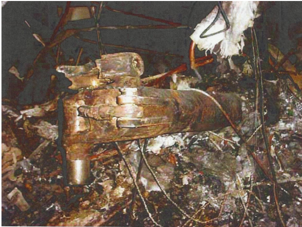
FIGURE 12.9 – Pièce de train d'atterrissage trouvée à l'intérieur du bâtiment, zone non écroulée.
