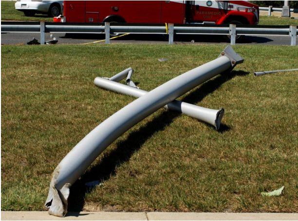
FIGURE 12.20 – Lampadaire renversé et cassé par le 757. Du côté du rail de sécurité, on voit très bien la rupture du socle selon les règles de sécurité.
