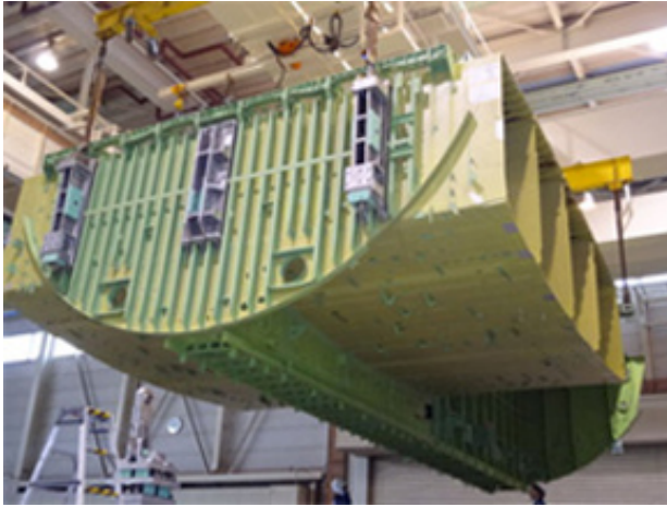
FIGURE 11.14 – Tronçon capable de beaucoup de dégâts dans sa trajectoire intérieure au bâtiment, celui comportant attache des ailes, réservoir principal et trains d’atterrissages principaux. Les renforts visibles se passent de commentaires. Dans la partie qui sera cachée lors du montage définitif, on retrouve la couleur de la peinture de protection visible sur certaines pièces dans les débris du crash
